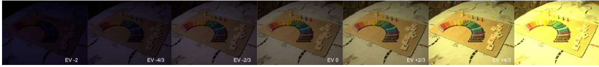
Rysunek 5.6: Zmiana ekspozycji zdjęcia z serii nr 1 w znormalizowanej przestrzeni R_T G_T B_T .
